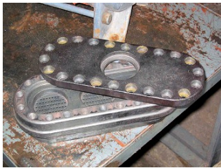
Trainingsobjekt mit praktischem Bezug und Wert: eine Spinnndüse aus der Nylonfertigung
